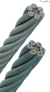
KALS (カルス) ロープは、American Chain & Cable Co., Ltd. から技術導入した溶融アルミニウムめっきを施し、後伸線法でロープ素線を製造したロープです。アルミニウムめっきは、アルカリ性以外の環境下で亜鉛に比べて耐食性が良く、特に海水中や海洋性環境下において優れており、船舶漁業関係や海洋開発関係で抜群の効果を発揮し、多数採用をいただいております。更に、耐熱性とともに硫黄化合物に対する抵抗力が大きく、工業地帯や火山温泉地帯でも優れた特性を発揮します。KAL-G (カルジ) ロープは、亜鉛+アルミニウム合金めっきを施し、後伸線法によってロープ素線を製造したロープで、JISによる塩水噴霧試験では、亜鉛めっきの2~3倍以上の耐食性を保つ優れた特性を有しています。
